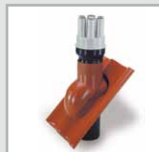
MSD 110 z siedmioma króćcami i siedzioma rurami termokurczliwymi Jeden króciec jest w momencie dostawy zamknięty, w razie potrzeby może zostać otwarty. Odpowiedni do maksymalnie czterech kabli o średnicy 7 - 23 mm i maksymalnie trzech kabli o średnicy 7 - 30 mm. Dostępne akcesoria: głowiczki AK lub korki zaślepiające VS 25 i VS 32 MSD 110/D7/32/25
