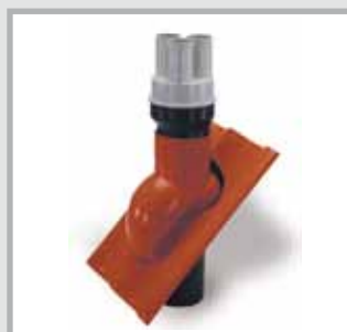
MSD 110 z trzema króćcami i trzema rurami termokurczliwymi Odpowiedni do trzech kabli o średnicy 16 - 44 mm. Dostępne akcesoria: głowiczki AK lub korki zaślepiające VS 46. MSD 110/D3/46
